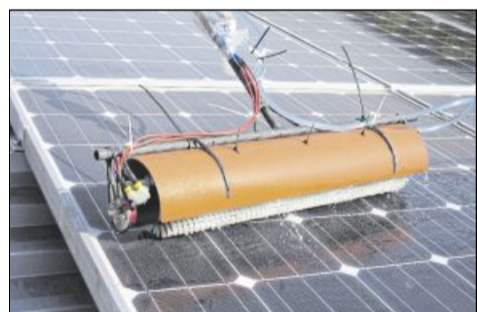
Die Walze, ihre Schutzabdeckung und ihre Zuleitungen: Ein ausgeklügeltes, aber einfach und zuverlässig arbeitendes System.
